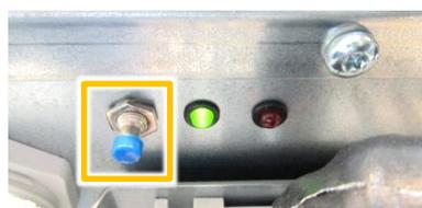
**HINWEIS:** Der SMA Sunny Island wird nach Aktivierung der Batterie ca. 30s vorgeladen. Danach blinken beide LEDs.
